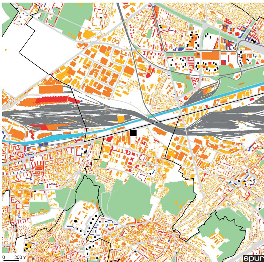
L'exploitation des photos aériennes à haute résolution a permis d'établir de façon détaillée et précise, les emprises des bâtiments avec leurs hauteurs associées. Cette carte montre la densité des constructions par leur hauteur.
